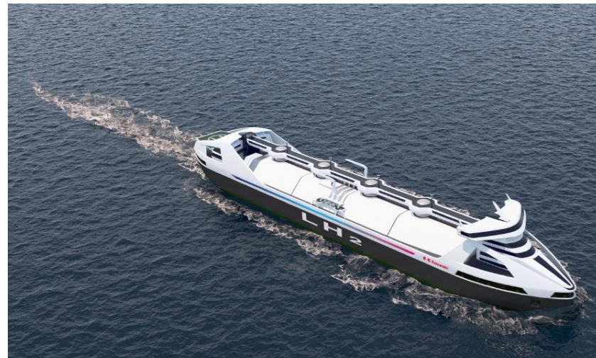
液化水素運搬船 (建造中・イメージ)
